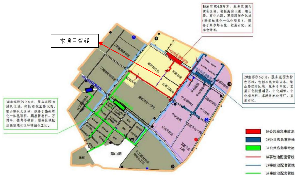
图 5.2-1 石化基地公共应急事故池示意图
