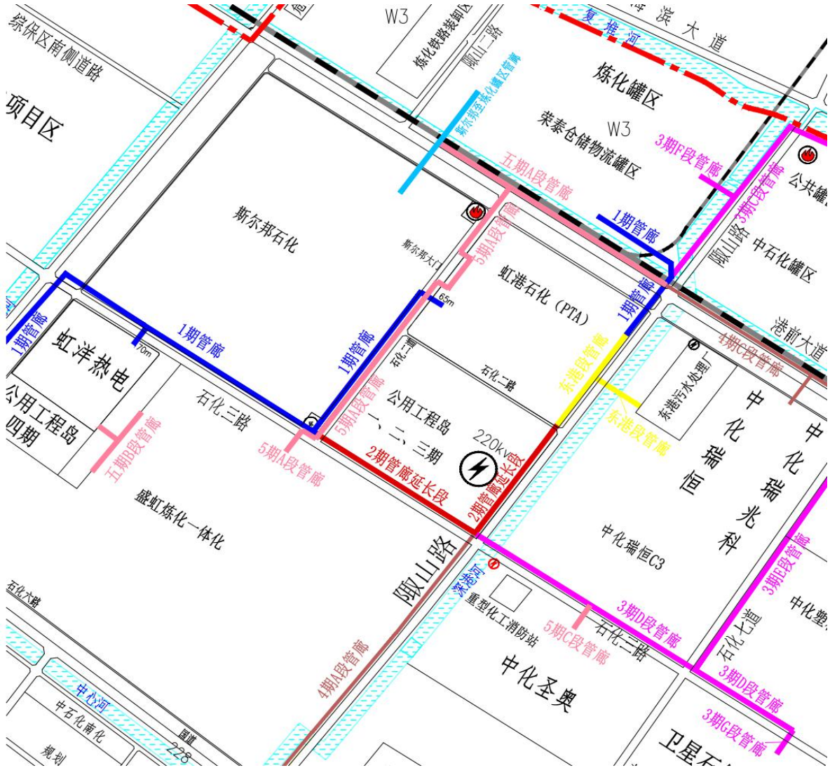
图 10-3 五期管廊路由示意图
