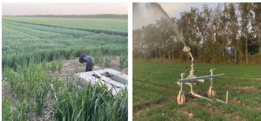
图 7.2-4 农田内设置液体肥料输送接口及喷洒装置
