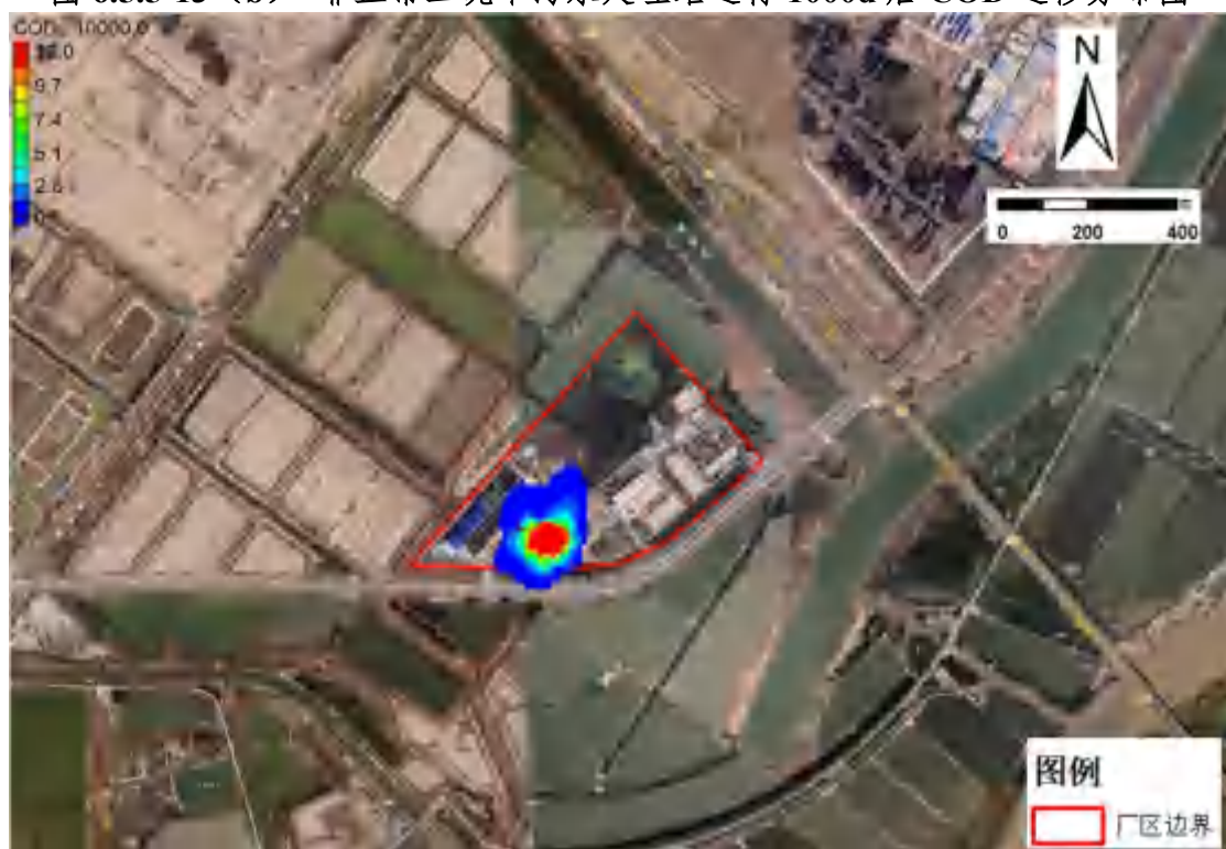
图 6.5.5-13 (c) 非正常工况下污水处理站运行 10000d 后 COD 运移分布图
