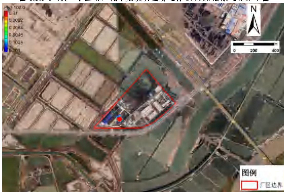
图 6.5.5-7 (a) 非正常工况下危废填埋场运行 100d 后铅运移分布图
