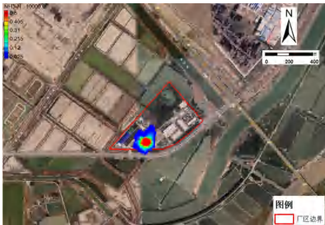
图 6.5.5-14 (c) 非正常工况下污水处理站运行 10000d 后氨氮运移分布图
