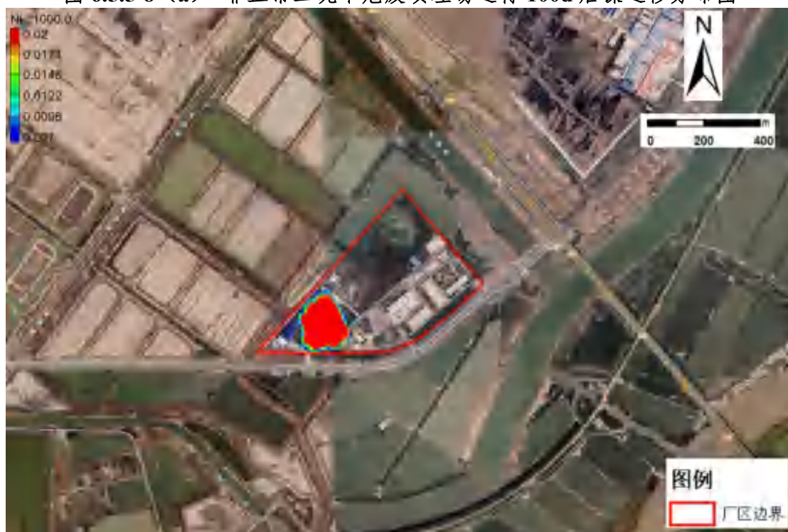
图 6.5.5-8 (b) 非正常工况下危废填埋场运行 1000d 后镍运移分布图
