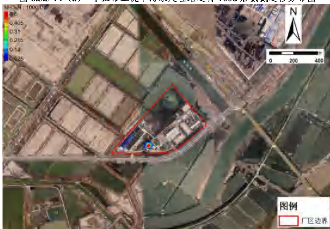
图 6.5.5-14 (b) 非正常工况下污水处理站运行 1000d 后氨氮运移分布图
