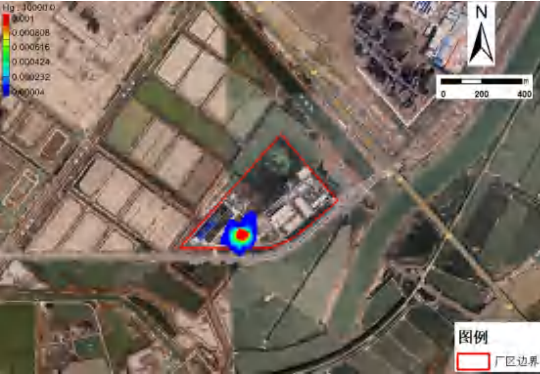
图 6.5.5-10 (c) 非正常工况下污水处理站运行 10000d 后汞运移分布图
