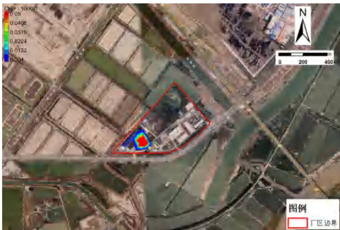
图 6.5.5-9 (b) 非正常工况下危废填埋场运行 1000d 后六价铬运移分布图
