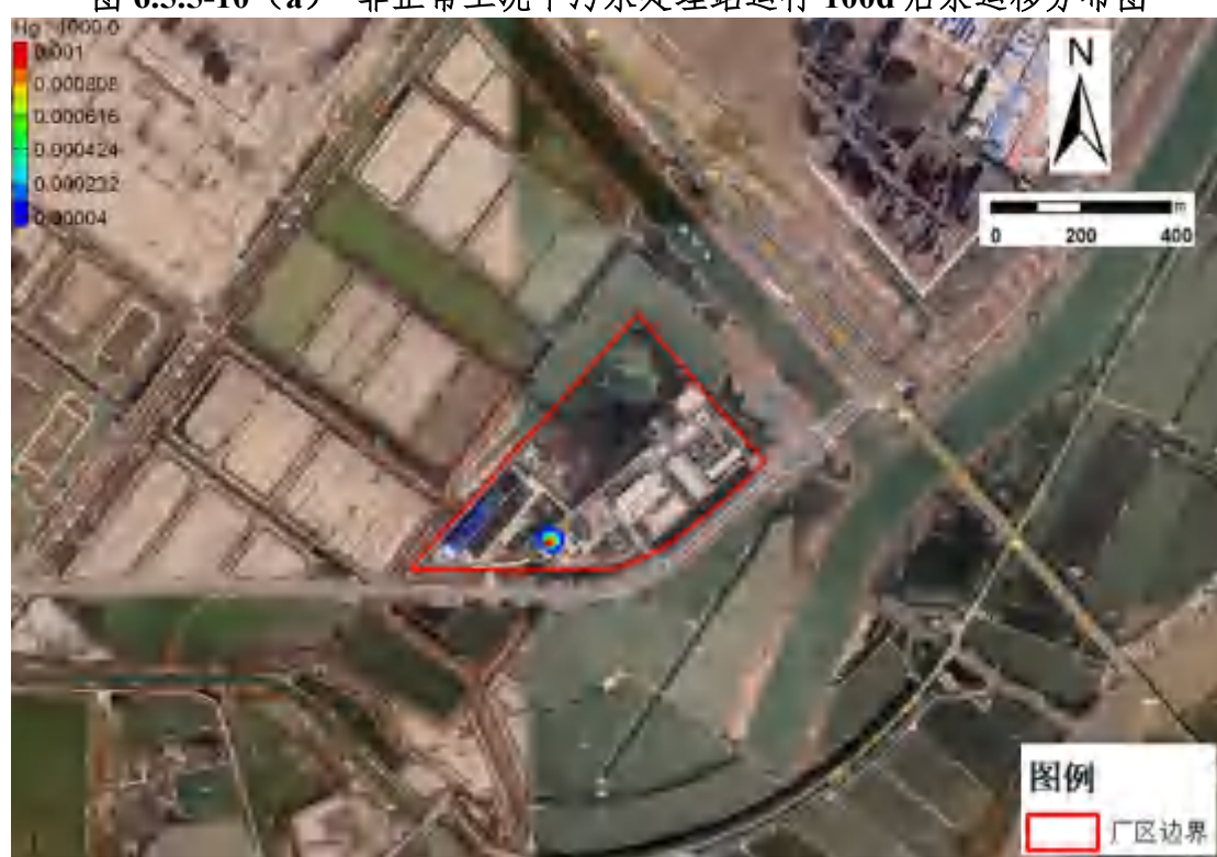
图 6.5.5-10 (b) 非正常工况下污水处理站运行 1000d 后汞运移分布图
