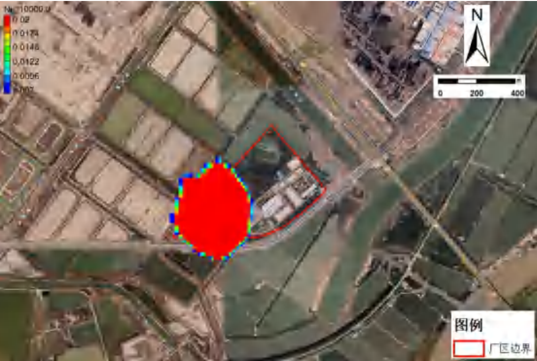
图 6.5.5-8 (c) 非正常工况下危废填埋场运行 10000d 后镍运移分布图
