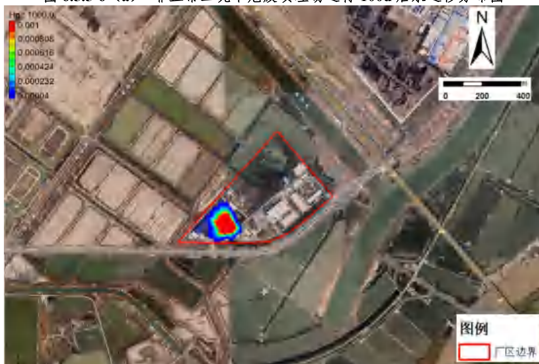
图 6.5.5-6 (b) 非正常工况下危废填埋场运行 1000d 后汞运移分布图
