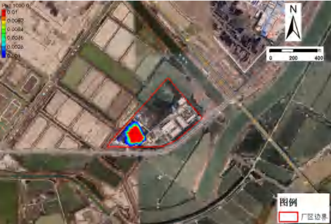
图 6.5.5-7 (b) 非正常工况下危废填埋场运行 1000d 后铅运移分布图
