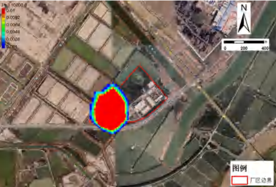
图 6.5.5-7 (c) 非正常工况下危废填埋场运行 10000d 后铅运移分布图
