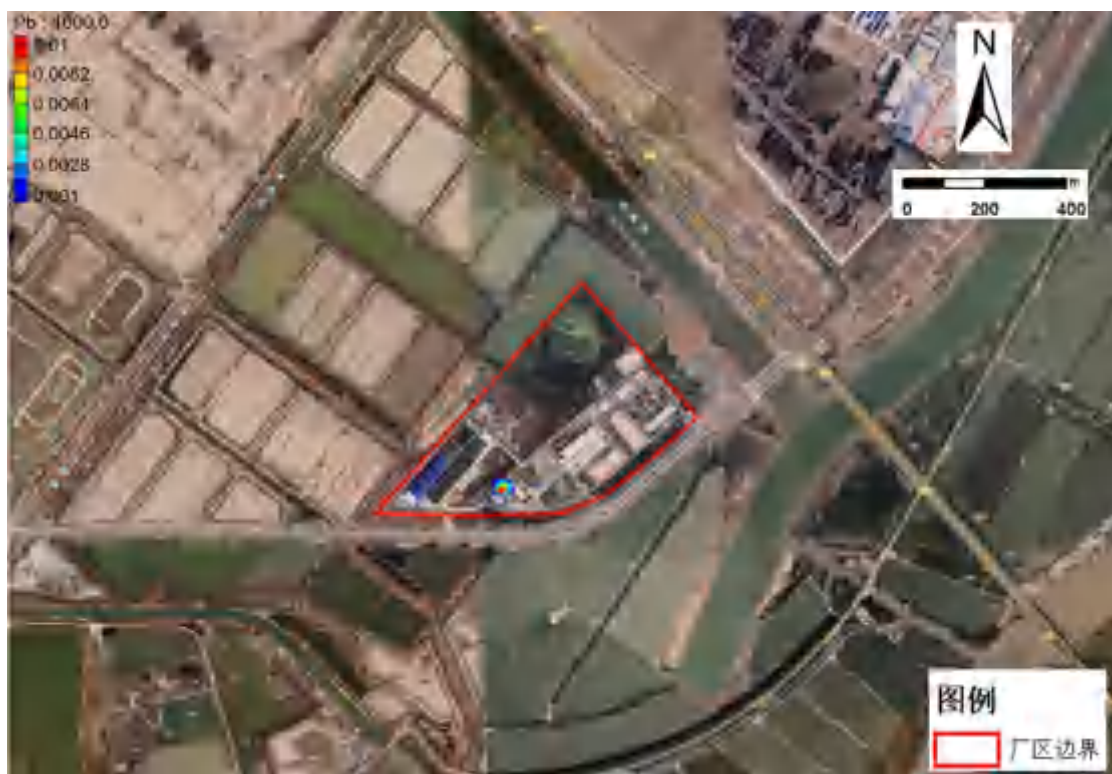
图 6.5.5-11 (b) 非正常工况下污水处理站运行 1000d 后铅运移分布图
