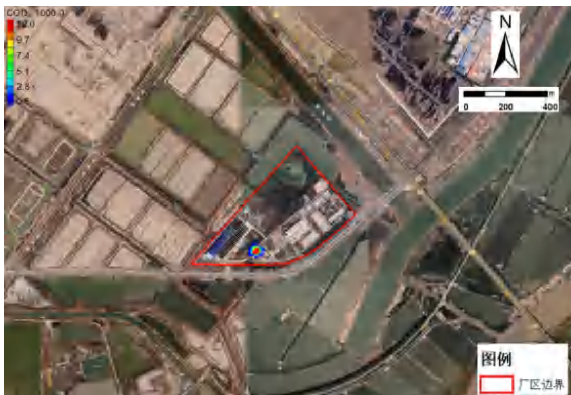
图 6.5.5-13 (b) 非正常工况下污水处理站运行 1000d 后 COD 运移分布图
