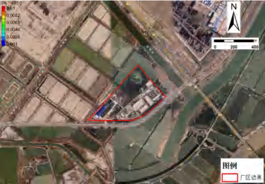
图 6.5.5-11 (a) 非正常工况下污水处理站运行 100d 后铅运移分布图
