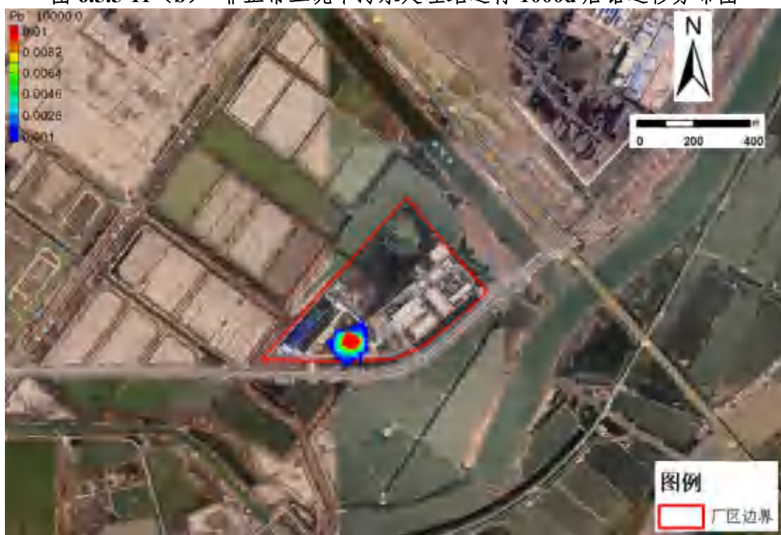
图 6.5.5-11 (c) 非正常工况下污水处理站运行 10000d 后铅运移分布图
