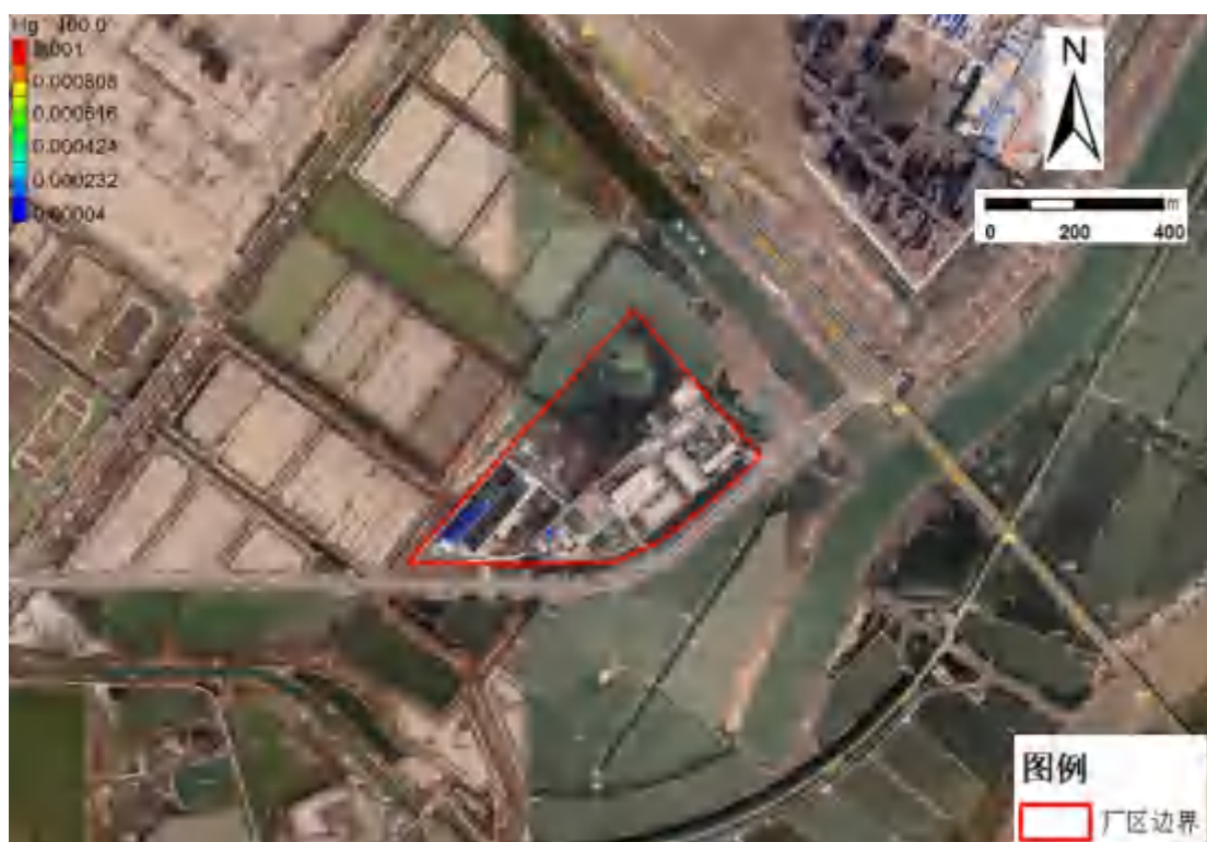
图 6.5.5-10 (a) 非正常工况下污水处理站运行 100d 后汞运移分布图
