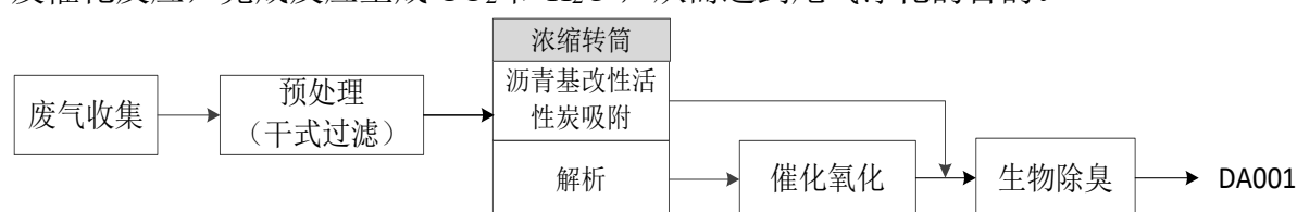
图 7.1-4 KW+CO 系统处理工艺流程图
